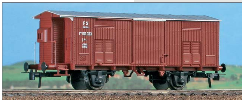
Carro chiuso FS Tipo F cassa in legno a passo corto, con garitta. Type F goods wagon with brakesman's cabin, red livery. Geschlossener Güterwagen Typ F der FS, Holzaufbau, kurzer Achsstand, mit Bremserhäuschen.
