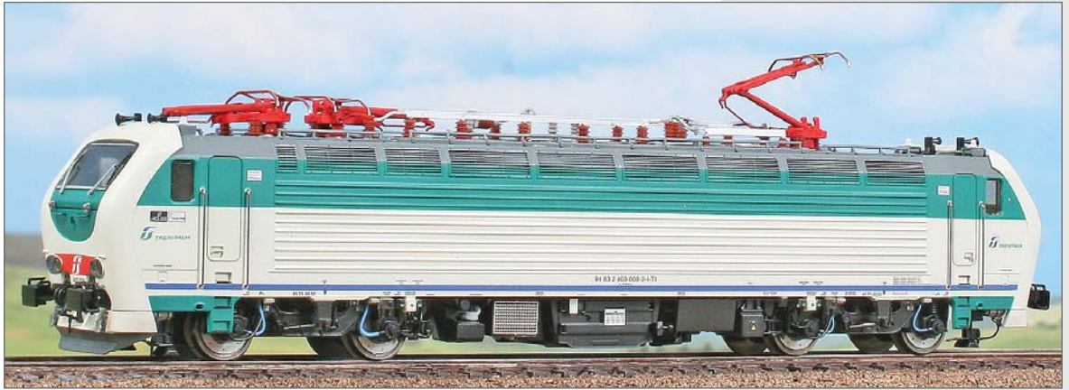
Locomotiva politemensione E.403.008, divisione passeggeri di Trenitalia, per la trazione di treni su lunghe distanze, livrea XMPR. Multi-voltage locomotive E.403.008 of Trenitalia, passenger division, used on long-distance trains. XMPR livery. Mehrstrom-Lok E.403.008 der Trenitalia, Division Fernverkehr, für Langstrecken-Züge. XMPR Lackierung.
