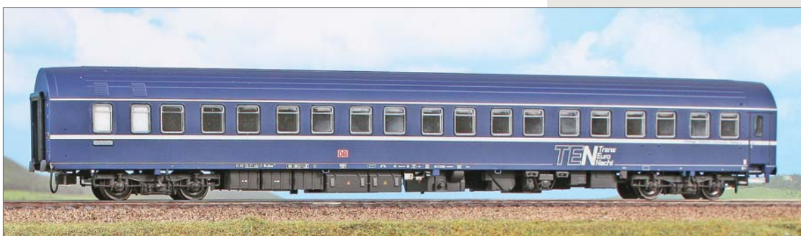
Carrozza letti DB Tipo T2s ricostruita e con finestrini modificati, livrea blu con logo TEN. DB Type T2s sleeping car with refurbished windows, blue livery, TEN logo. DB Typ T2S Schlafwagen mit rekonstruiert Fenstern, blaue Lackierung, TEN-Logo.
