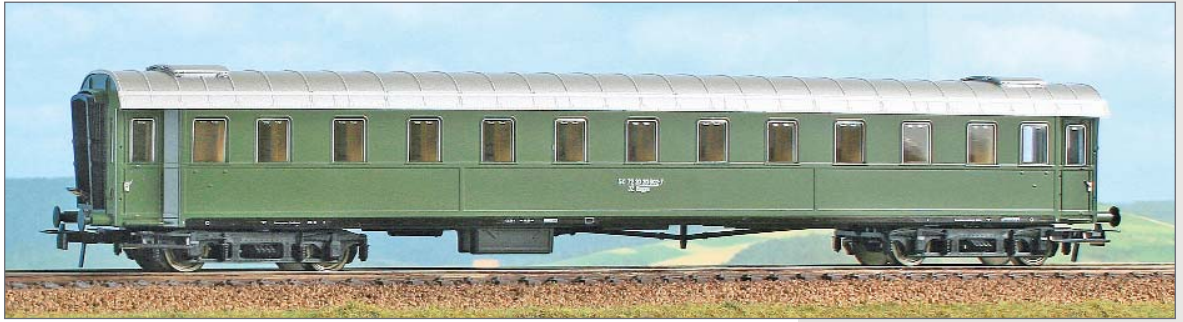
Carrozza di 2ª classe ex Tipo 1931 per il servizio internazionale nella livrea verde delle JŽ (Ferrovie Jugoslave). 2 nd class ex Type 1931 car, in the JŽ (Yugoslavian Railways) green livery, for international service. 2. Klasse ex Typ 1931 Wagen, in grüner JŽ (Jugoslawische Eisenbahnen) Lackierung, für internationale Züge.
