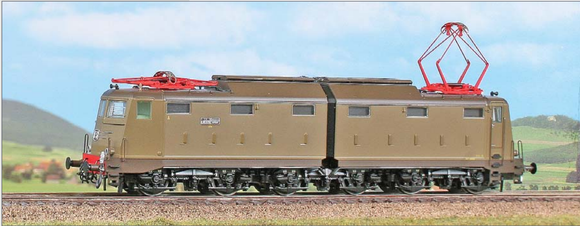
Locomotiva delle FS E.645 di prima serie, nella livrea castano e Isabella così come fotografata negli anni settanta. Pantografo Tipo FS 52 con archetto centinato. Epoca IV E.645 Italian Railways locomotive. First series model, two tone brown livery, Type 52 pantograph with curved blade. E-Lok E.645 der FS, Erste Bauserie, FS 52 Stromabnehmer, zweitönige braune Lackierung.
