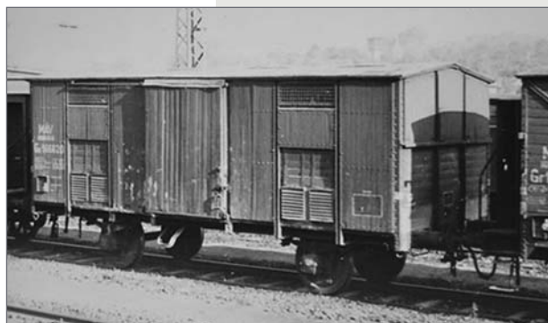
Carro chiuso Tipo F a passo corto, immatricolato presso le Ferrovie Ungheresi (MÁV). Type F goods wagon, red livery, of the Hungarian Railways (MÁV). Geschlossener Güterwagen Typ F der FS, kurzer Achsstand, bei der Ungarischen Eisenbahn (MÁV) eingestellt.
