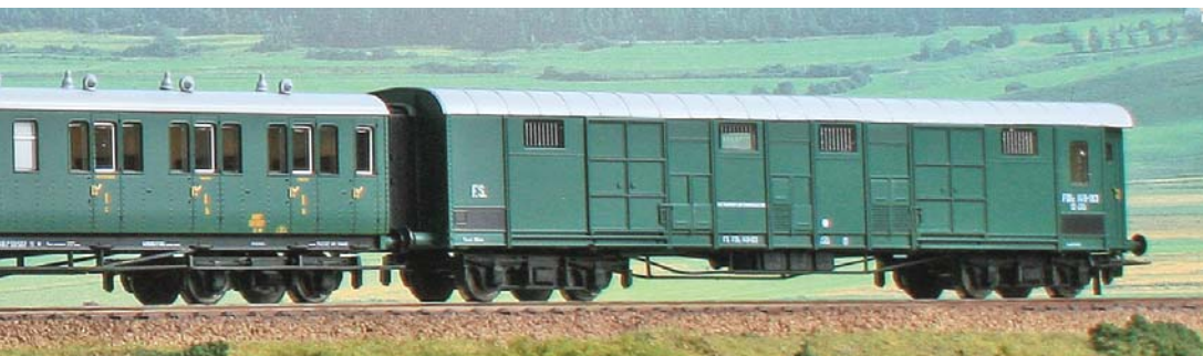
Carrozza FS di 3ª classe Tipo 31000, livrea di origine verde vagone. Italian Railways 3rd class Type 31000 in original green livery. 3. Klasse Typ 31000 Wagen der FS, in grüner Lackierung.
