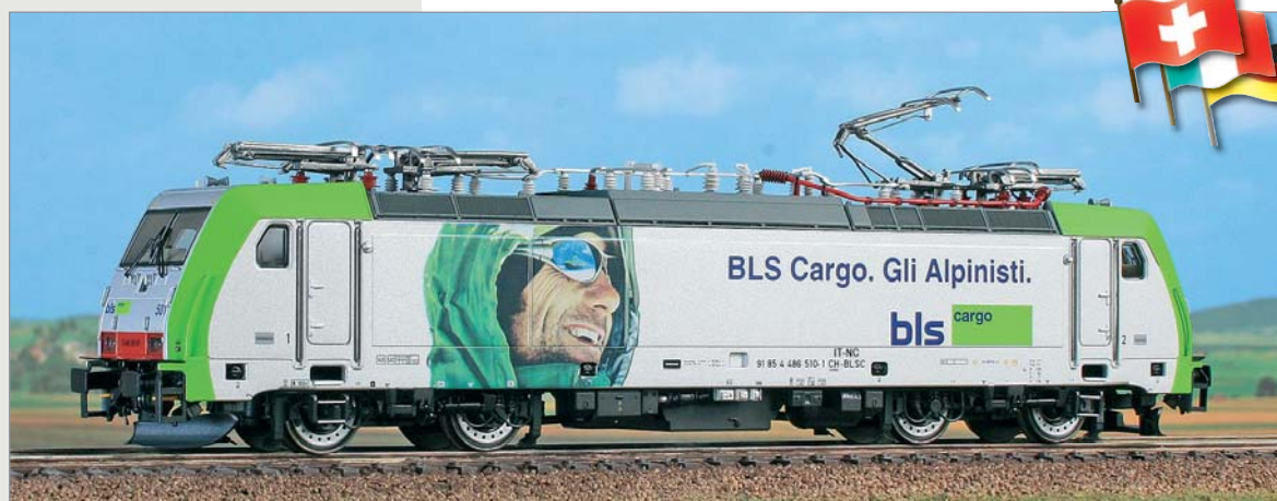
Locomotiva TRAXX F 140 MS nella livrea della compagnia BLS, con doppia immatricolazione italiana e svizzera 486.502 (BLS - SERFER) operante sulle reti ferroviarie italiana, svizzera e tedesca. TRAXX F 140 MS locomotive, in the BLS company "Die Alpinisten" livery, running in Italy, Switzerland and Germany. E-Lok TRAXX F 140 MS, in der BLS "Die Alpinisten" Lackierung, eingesetzt in Italien, Schweiz und Deutschland.
