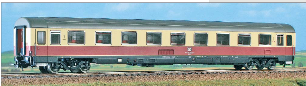
Carrozza DB Tipo Avmz207 di 1ª classe nella livrea originale rosso e crema con carenature nere e velocità 200 km/h. DB Type Avmz 207, 1 st class car, original livery red and cream with black fairings. Speed 200 km/h. DB Type Avmz 207.1 Erste-Klasse-Wagen, Originallackierung rot und creme mit schwarzen Verkleidungen. Geschwindigkeit 200 km / h.
