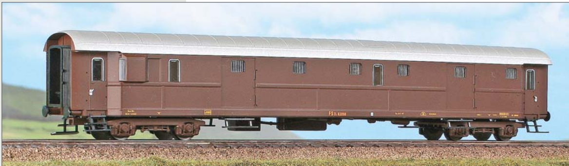
Bagagliaio FS Tipo 1946 (Dz 83000) in livrea castano, carrelli FS 27. Type 1946 luggage car (Dz 83000) of the FS, brown livery, Type FS 27 bogies. Typ 1946 Gepäckwagen der FS (DUz 83000), braune Lackierung, Typ FS 27 Drehgestelle
