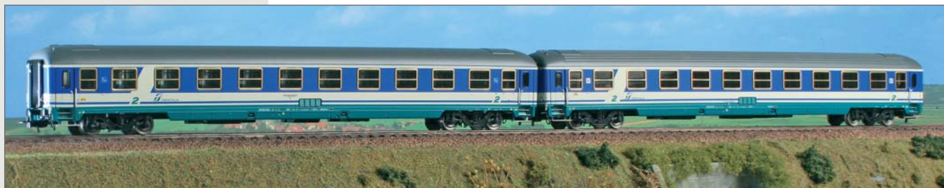
Due carrozze di 2ª classe Tipo X 1979 trasformate da esistenti carrozze di 1ª classe, una con il tetto liscio e l'altra con il tetto cannellato. Livrea XMPR della divisione passeggeri di Trenitalia.
