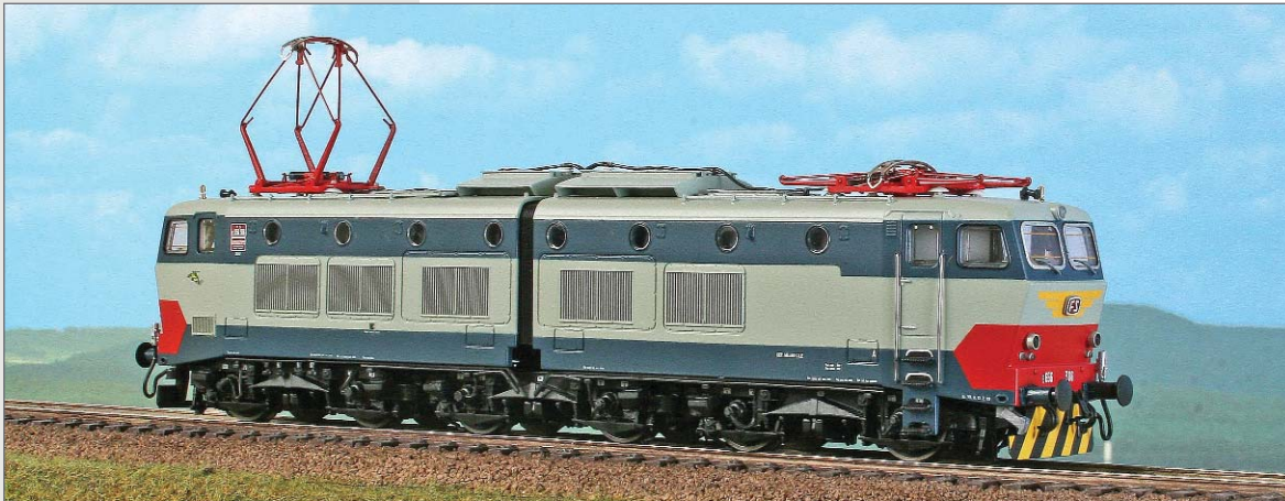
Locomotiva articolata delle FS E.656.306 (terza serie). Pantografi Tipo FS 52, respingenti tondi. E.656.306 Italian Railways locomotive (third series). Original livery, Type 52 pantographs, round buffers. E-Lok E.656.306 der italienischen Eisenbahnen (dritte Bauserie). Originallackierung, Typ 52 Stromabnehmer, runde Puffer.
