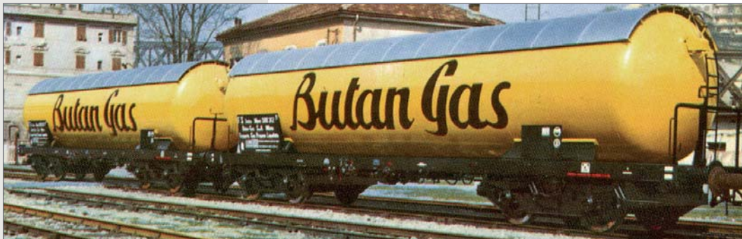
Coppia di carri cisterma Mbpz immatricolati presso le FS dalla società Butan Gas. Set of two Italian Railways Mbpz tank wagons, owned by Butan Gas. Set aus zwei Tankwagen Mbpz, von der Gesellschaft Butan Gas bei der FS eingestellt.
