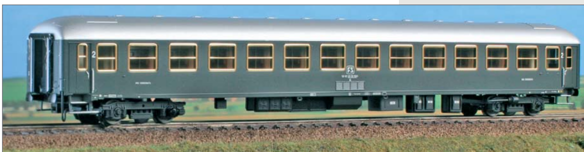
Carrozza di 2ª classe del Tipo X 1968 delle FS, prototipo con aria condizionata e carrelli FS del tipo 24 Au. Il modello riproduce esattamente la vettura con l'impianto di condizionamento sperimentale Brown Boveri.
