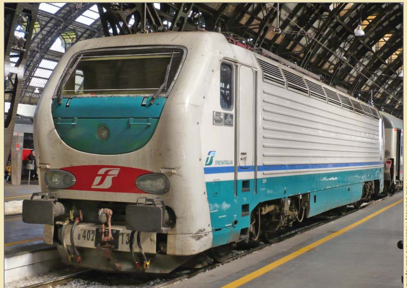
Locomotiva politemensione E.403.008, divisione passeggeri di Trenitalia, per la trazione di treni su lunghe distanze, livrea XMPR. Multi-voltage locomotive E.403.008 of Trenitalia, passenger division, used on long-distance trains. XMPR livery. Mehrstrom-Lok E.403.008 der Trenitalia, Division Fernverkehr, für Langstrecken-Züge. XMPR Lackierung.
