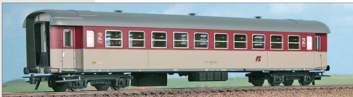
Carrozza FS di 2 a classe serie Tipo 1956R (Bz 30800) in livrea beige e rosso fegato. Carrelli FS 27. 2 nd class Type 1956R (Bz 30800) FS car. Type FS 27 bogies, Type Klein windows, beige and deep red livery. 2. Klasse Wagen Typ 1956R (Bz 30800) der FS, Typ FS 27 Drehgestelle, Typ Klein Übersetzfenster, beige und leberrote Lackierung.
