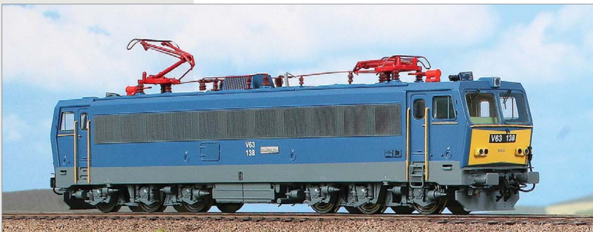
Locomotive elettrica V63 138 delle ferrovie statali ungheresi (MAV) per treni passeggeri, con targhe laterali "Kalman Kando". MÁV (Hungarian State Railways) locomotive V63 138, with gearing for passenger trains, with side plates "Kalman Kando". E-Lok der MAV (Ungarische Staatsbahnen) V63 138, mit Getriebeübersetzung für Reisezüge, mit seitlichen Schildern "Kalman Kando".
