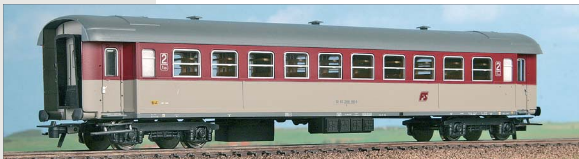
Carrozza FS di 2 a classe serie Tipo 1956R (Bz 30800) in livrea beige e rosso fegato. Carrelli FS 27. 2 nd class Type 1956R (Bz 30800) FS car. Type FS 27 bogies, Type Klein windows, beige and deep red livery. 2. Klasse Wagen Typ 1956R (Bz 30800) der FS, Typ FS 27 Drehgestelle, Typ Klein Übersetzfenster, beige und leberrote Lackierung.
