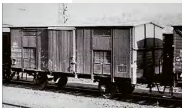
Carro chiuso Tipo F a passo corto, immatricolato presso le Ferrovie Ungheresi (MÁV). Type F goods wagon, red livery, of the Hungarian Railways (MÁV). Geschlossener Güterwagen Typ F der FS, kurzer Achsstand, bei der Ungarischen Eisenbahn (MÁV) eingestellt.
