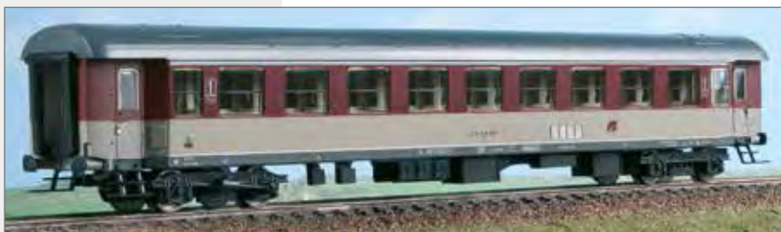
Carrozza FS di 1ª cl. Tipo 1946T in livrea beige e rosso fegato con intercomunicanti moderni. 1 st class Type 1946T car of the FS with new transition doors. Beige and deep red livery. 1. Klasse Typ 1946T Wagen der FS mit neuem Wagenübergang. Beige und leberrote Lackierung.
