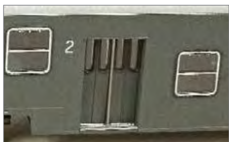
Mancorrente centrale fornito come accessorio da montare. Central handrail, delivered as spare part, to be assembled. Der mittlere Haltegriff ist als Zursüßteil beigelegt und kann montiert werden.
