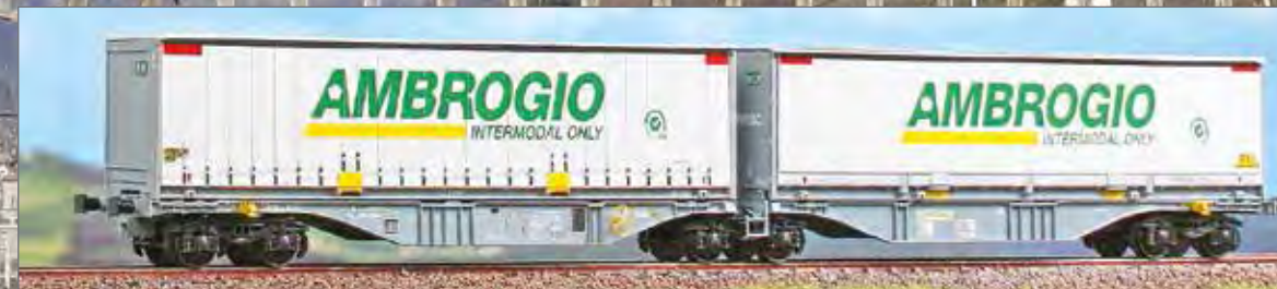
Carro intermodale Tipo Sggmrss '90 bimodulo di proprietà Ambrogio caricato con due casse mobili "Ambrogio" Container wagon Type Sggmrss '90 Ambrogio with two "Ambrogio" swap bodies Containerwagen Typ Sggmrss '90 Doppelmodul der Ambrogio mit zwei "Ambrogio" Wechselpritschen
