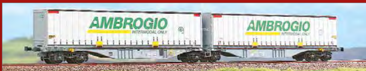
Carro intermodale Tipo Sggmrss '90 bimodulo di proprietà Ambrogio caricato con due casse mobili "Ambrogio" Container wagon Type Sggmrss '90 Ambrogio with two "Ambrogio" swap bodies Containerwagen Typ Sggmrss '90 Doppelmodul der Ambrogio mit zwei "Ambrogio" Wechselpritschen
