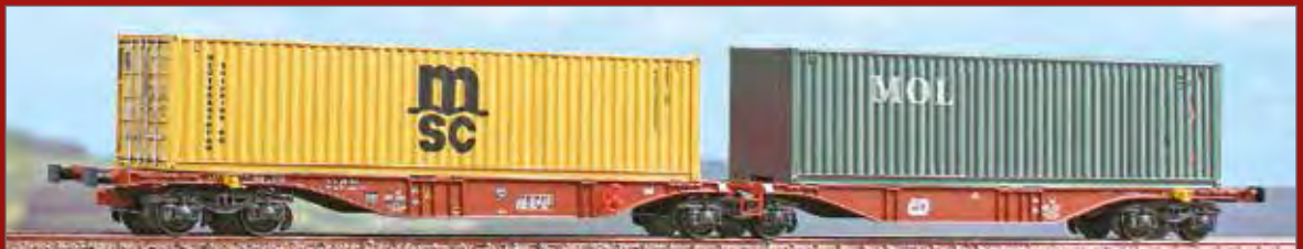
Carro intermodale Tipo Sggmrss '90 bimodulo di proprietà CD Cargo caricato con due container da 40 piedi "MSC" e "MOL" Container wagon Type Sggmrss '90 CD Cargo with two "MSC" and "MOL" containers Containerwagen Typ Sggmrss '90 Doppelmodul der CD Cargo mit "MSC" und "MOL" Containern
