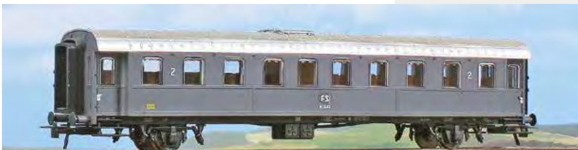
Carrozza FS di 2ª classe Tipo 1936 (BI 35000), sospensioni a balestra singola, livrea grigio ardesia. 2 nd class Type 1936 Italian Railways car (BI 35000), single leaf spring, slate gray livery. 2. Klasse Wagen BI 35000-Serie (Typ 1936) der FS, zwei Achsen, mit Einzelfederung schiefergraue Lackierung.
