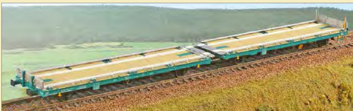
Carro pianale tipo Laadgrs per trasporto veicoli di grandi dimensioni, utilizzati in treni blocco su relazioni nazionali ed internazionali Type wagon for trucks transport, used in national and international trains. Flachwagen Typ Laadgrs für Lieferwagen und größere Fahrzeuge, in Ganzzügen national wie international eingesetzt.
