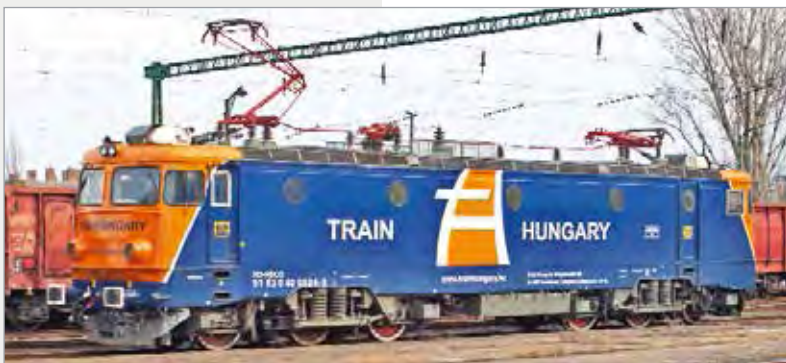
Locomotore classe EA 060 di costruzione rumena nella livrea dell'operatore Train Hungary. Class EA 060 electric locomotive, built by Rumanian company Electroputere Craiova and owned by Train Hungary. Elektrolokomotive EA 060 rumänischer Bauart, in den Farben des Bahnunternehmens Train Hungary.
