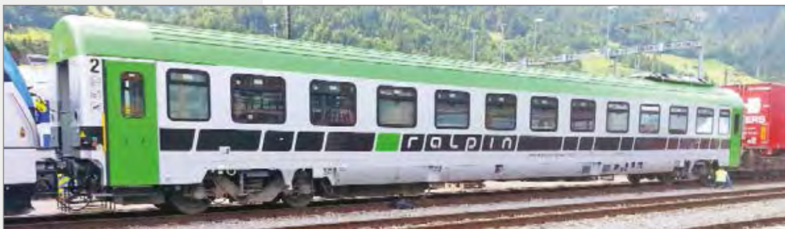
Carrozza appoggio per treni "Rollende Landstrasse" della società Ralpin. Support car of the Ralpin society, for "Rollende Landstrasse" trains. Ralpin-Begleitwagen für "Rollende Landstrasse"-Züge.
