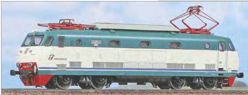
Locomotiva elettrica FS E.444R nelle condizioni odierne, con conduttori a 13 poli per il comando delle porte del treno. Electric Locomotive FS E.444R in today's conditions, with 13-pin cable for independent side control of the train doors. E-Lok E.444R der FS in derzeitiger Version, mit 13-Pol-Kabel für die seitenabhängige Steuerung der Zugtüren
