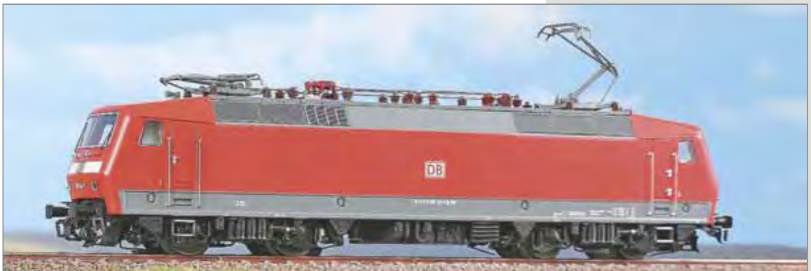
Locomotiva elettrica 120 141 della DB allo stato attuale, con predellini piccoli e quattro mancorrenti sul frontale. Electric Locomotive 120 141 of the DB, actual status, with small stairs and four front handrails. E-Lok 120 141 der DB in aktuellem Zustand, mit schmalen Rangiertritten und vier Handgriffen auf der Front.
