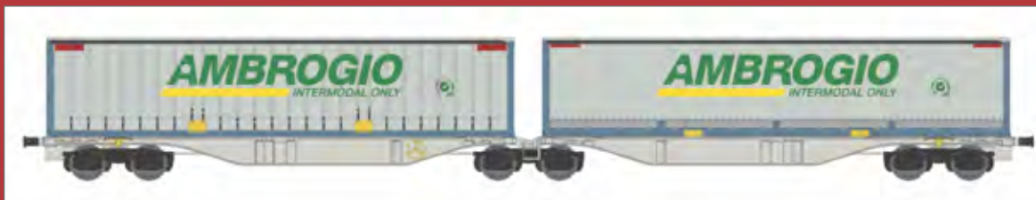
Carro intermodale Tipo Sggmrss '90 bimodulo noleggiato "Ambrogio" con carico di casse mobili. Container wagon Type Sggmrss '90 hired by "Ambrogio" with swap bodies. Containerwagen Typ Sggmrss '90 Doppelmodul vermietet an "Ambrogio" mit Wechselpritschen.
