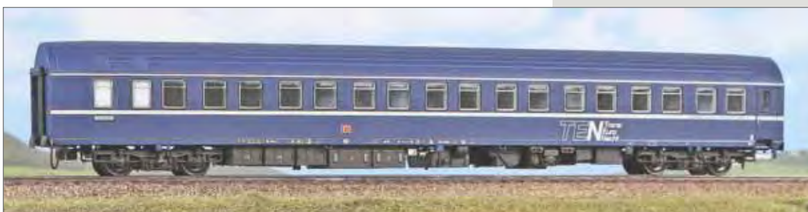
Carrozza letti DB Tipo T2s ricostruita e con finestrini modificati, livrea blu con logo TEN. DB Type T2s sleeping car with refurbished windows, blue livery, TEN logo. Schlafwagen, rekonstruiert mit neuen Fenstern
