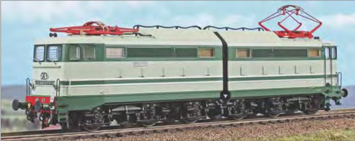
Locomotiva FS E.646.073 modificata con prese d'aria a persiana su una sola fiancata, ancora dotata di modanature. Electric locomotive E.646.073 of the Italian Railways with modified air intakes on one side, still with mouldings. E-Lok E.646.073 der italienischen Staatsbahnen mit neuen Lüftern auf einer Seite umgebaut, noch mit Zierleisten ausgestattet.
