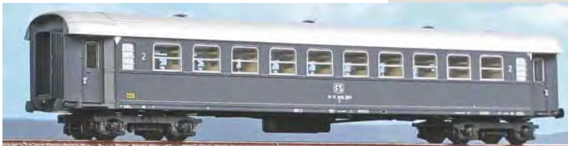
Carrozza di 2ª classe tipo 1956 R (Bz 30.800) in livrea grigio ardesia con finestrini Klein e carrelli 27. 2 nd class Type 1956R FS car, slate grey livery, type 27 bogies.
