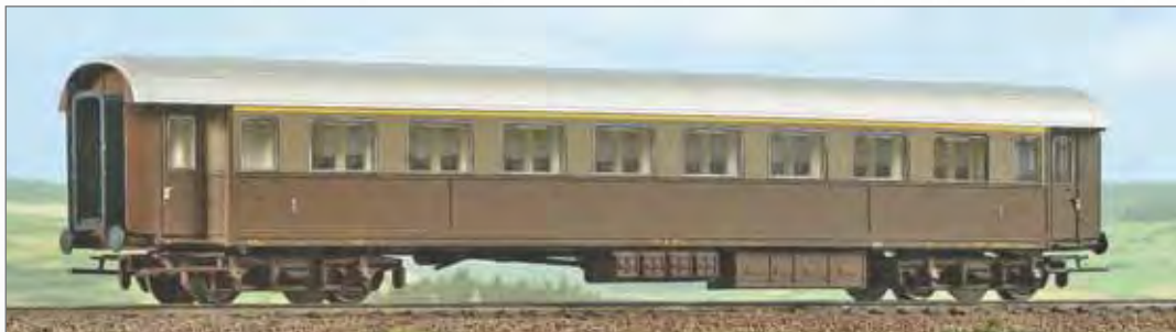
Carrozza FS di 1ª classe Tipo 1955R (Az 20500), livrea castano e Isabella di origine. Carrelli Tipo FS ABM con boccole a rulli. 1 st class Type 1955R (Az 20500) FS car. Type FS ABM bogies with roller bush, two tone brown livery. 1. Klasse Wagen Typ 1955R (Az 20500) der FS, Typ FS ABM Drehgestelle mit Rollenlager, zweitönige braune Ursprungslackierung.
