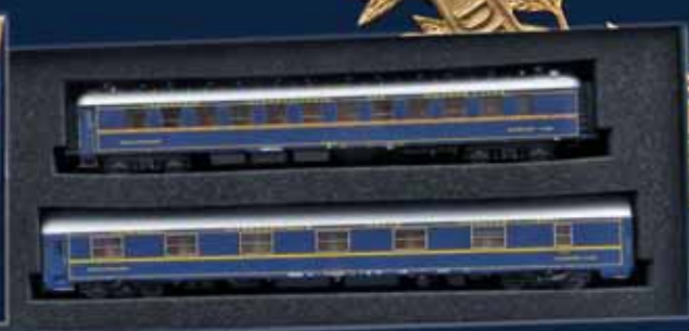
Carrozza letti Ub 3840 (Parco FS) con intercomunicanti ricostruiti e carrelli MD, nella fase finale del servizio, senza scritte CIWL. Ex CIWL sleeping car Ub 3840, (Italian fleet) modernized with new transition and MD boogies, in the final time of services, without CIWL inscriptions. Ehemaliger CIWL-Schlafwagen Ub 3840 (Italienischer Wagenpark), modernisiert mit neuen Übergängen und MD-Drehgestellen, in der letzten Einsatzzeit, ohne CIWL-Anschriften.
