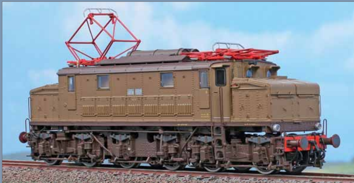
Locomotiva elettrica E626.362 in epoca V con cassa modificata e pantografi 42. Electric locomotive E626.362 in epoch V with modified body and Type 42 pantographs. Elektrolokomotive E626.362 mit modifiziertem Lokkasten und Typ 42 Stromabnehmer.
