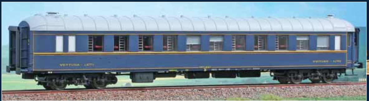
Carrozza letti Ub 3840 (Parco FS) con intercomunicanti ricostruiti e carrelli MD, nella fase finale del servizio, senza scritte CIWL. Ex CIWL sleeping car Ub 3840, (Italian fleet) modernized with new transition and MD boogies, in the final time of services, without CIWL inscriptions. Ehemaliger CIWL-Schlafwagen Ub 3840 (Italienischer Wagenpark), modernisiert mit neuen Übergängen und MD-Drehgestellen, in der letzten Einsatzzeit, ohne CIWL-Anschriften.
