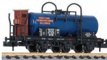
Mit 180-hl-Kessel, Bremserhaus und Speichenrädern
