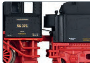
Elektrisch leitende Kurzkupplungen zwischen Lok und Tender
