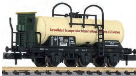
Mit 188-hl-Kessel, Bremserhaus und Speichenrädern
