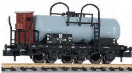
Mit 300-hl-Kessel und Bremserbühne
