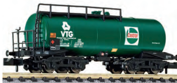
Mit 480-hl-Kessel und Bremserbühne
