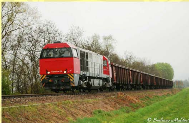
G2000 FER al traino di carri Eanos e Thanos – Foto di Emiliano Maldini
