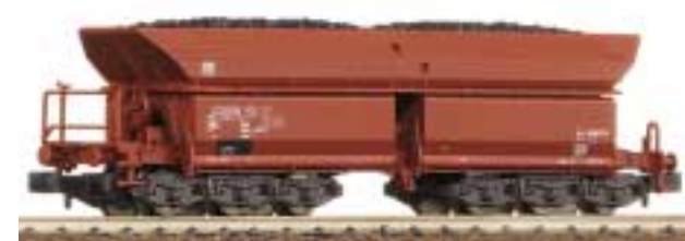
Offener Selbstentladewagen für Erztransport. Handmuster Faals 150
