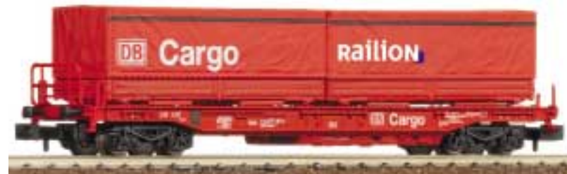
Einheitstaschenwagen, beladen mit zwei Wechselpritschen.
