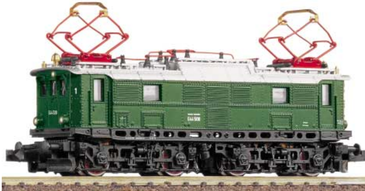
Elektrolokomotive E 44 5 , Achsfolge Bo'Bo'. Gehäuse aus Kunststoff, Rahmen aus Metallspritzguss. Antrieb auf alle vier Achsen, zwei Räder mit Haftreifen.
