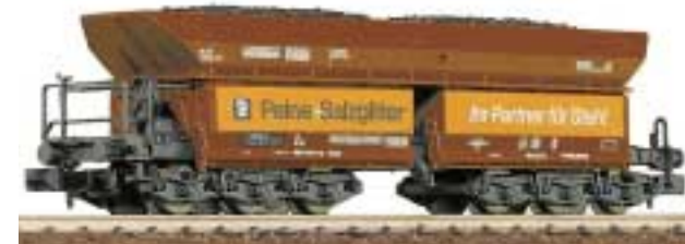
Offener Selbstentladewagen für Erztransport.
