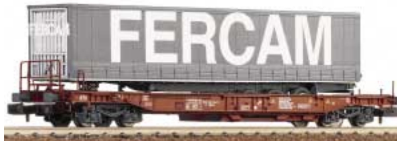
Einheitstaschenwagen der FS, beladen mit einem Schiebeleplanaufleger.
