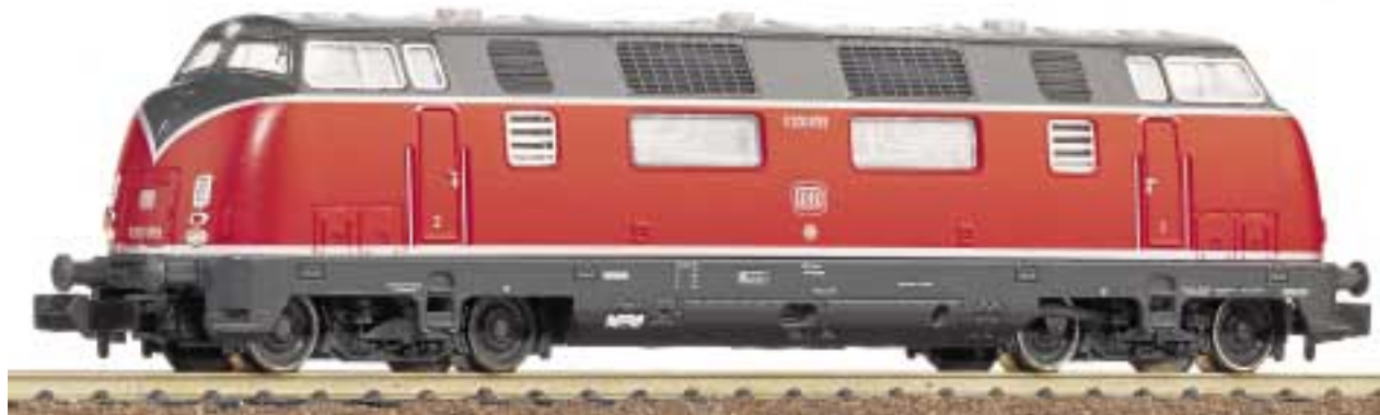
Diesellokomotive V 200, Achsfolge B'B'. Modell der V 200 059 mit DB-Logo und Zierstreifen. Gehäuse aus Kunststoff, Rahmen aus Metallspritzguss. Antrieb auf alle vier Achsen, Motor mit Schwungmasse, vier Räder mit Haftreifen.
