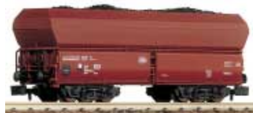
Vierachsiger Selbstentladewagen. Dieser Wagen wird sehr oft zum Transport von Kohle oder Erz in „Ganzzügen“ eingesetzt. Fac 159
