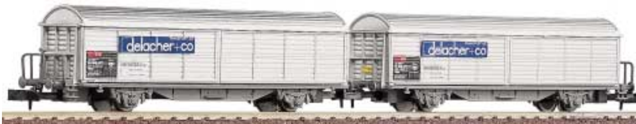
Festgekuppelte Doppelwageneinheit der österr. Spedition „Delacher“, bestehend aus zwei gedeckten Güterwagen, eingestellt bei den SBB.
