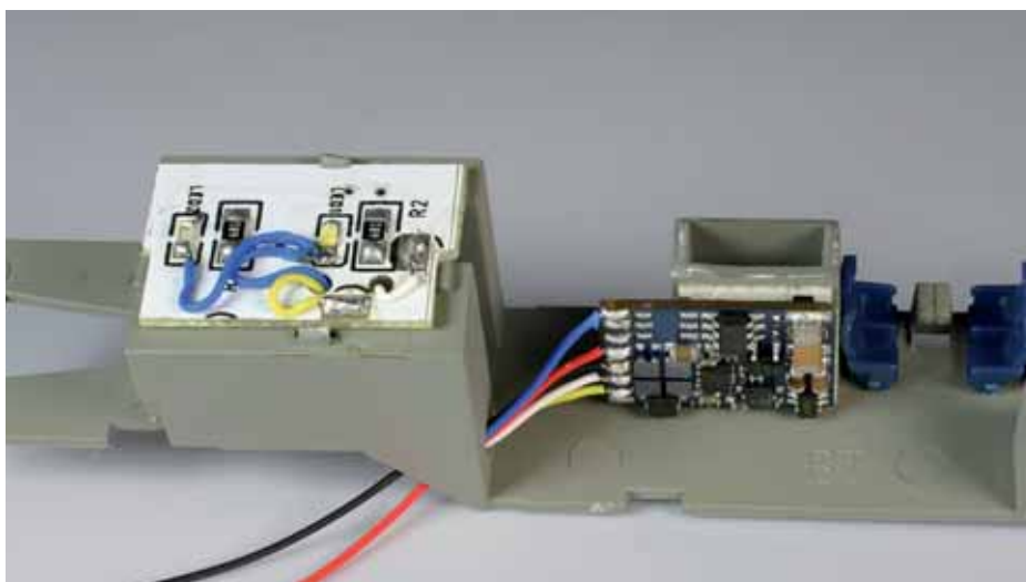
Die Kabel sind durchgeführt und verlötet, nun müssen noch die schwarzen und roten Litzen verbunden werden.
