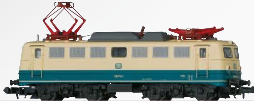
*Das gleiche ist nicht dasselbe. Ein Teil der Güterzuglokomotive der BR E 40 wurde mit einer zusätzlichen elektrischen Bremse der BR E 10 ausgerüstet und war damit steilstreckentauglich. Mit der Einführung des UIC Nummernsystems wurden diese Lokomotiven als BR 139 bezeichnet.*
