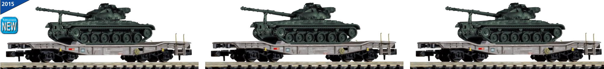
94400 Drei Panzertransportwagen Typ Slmmnps der SBB mit unterschiedlichen Wagennummern, beladen mit 3 Panzern 68, Ep. V
