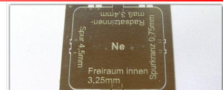
Ne-521.1: Spurlehre für Ne mit 4,5mm Spurweite für Gleis- und Weichenbau, zum Einstellen der Radsätze
