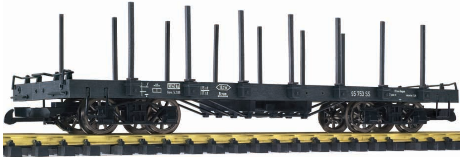
L95752 / L95753: Erhabene Schilder von verschiedenen Bahngesellschaften liegen zum Aufstecken bei. Wagen serienmäßig mit Metallrädern und handelsüblicher Kupplung.
