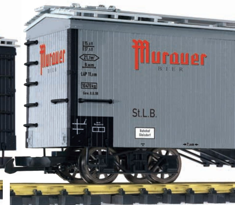
L95752 / L95753: Erhabene Schilder von verschiedenen Bahngesellschaften liegen zum Aufstecken bei. Wagen serienmäßig mit Metallrädern und handelsüblicher Kupplung.
