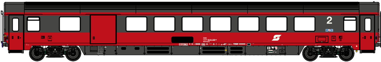
47 701 BDmpsz 82-91.0, Halbgepäckwagen behindertengerecht, umbragrau/verkehrsrot, Zuglaufschild-Halter, Drehgestelle MD522 Ep. V
