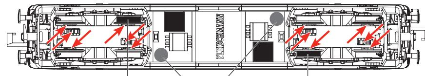
An den markierten Stellen kann der Schaltmagnet 942701 eingebaut werden.
