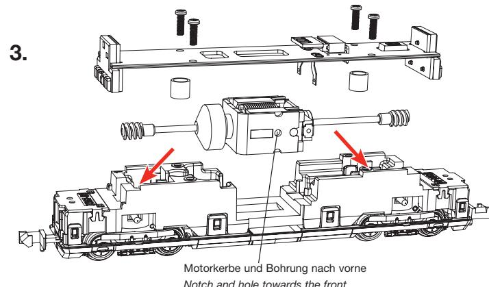
Motorkerbe und Bohrung nach vorne
