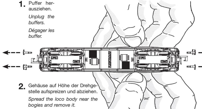
2. Gehäuse auf Höhe der Drehgestelle aufsprennen und abziehen.
