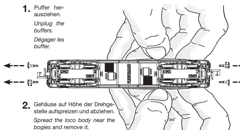
2. Gehäuse auf Höhe der Drehgestelle aufspreizen und abziehen.
