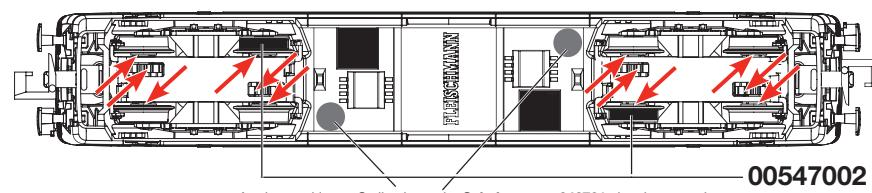
An den markierten Stellen kann der Schaltmagnet 942701 eingebaut werden.
