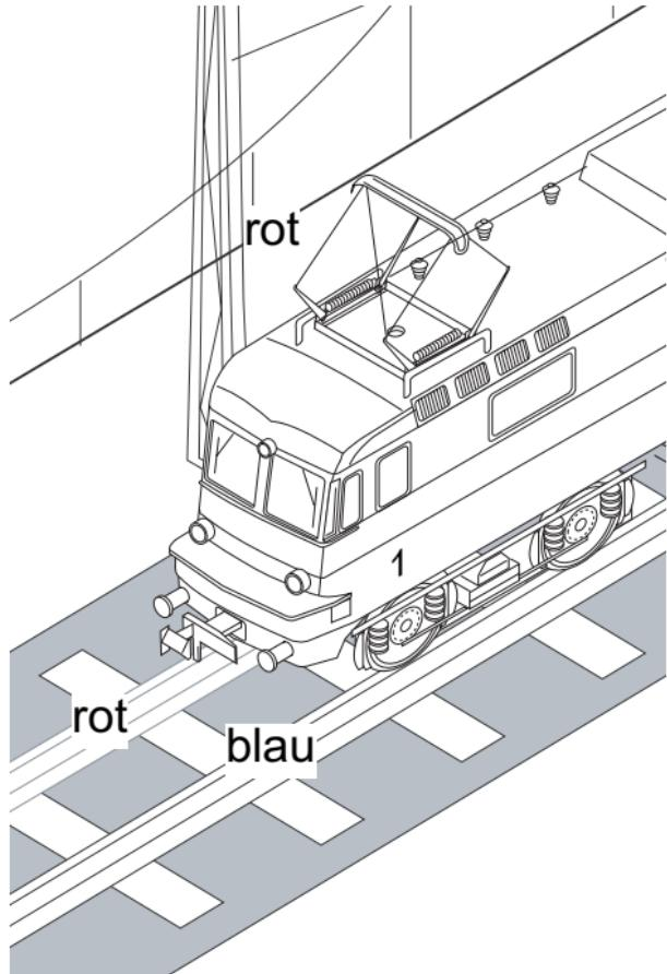
Einbau des Lok-Decoders mit der schwarzen Vergußmasse nach oben.
