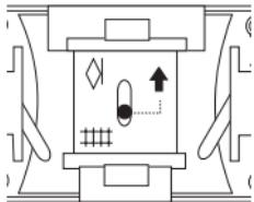
Bei Oberleitungsbetrieb beachten: Lok in Fahrtrichtung 1 (Führerstand 1) mit den linken Rädern auf die mit dem blauen Kabel verbundene Schiene stellen.
