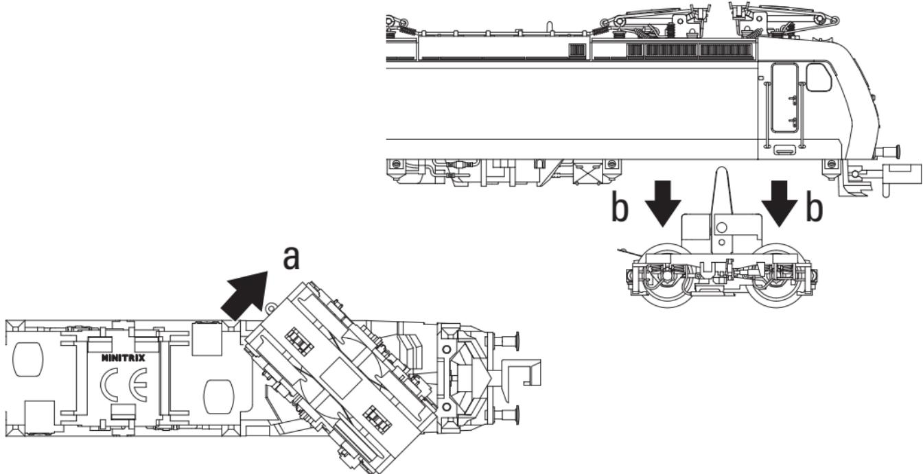
Einbau des Lok-Decoders mit der schwarzen Vergussmasse nach oben. Anschlussdrähte des Decoders nicht kürzer als 5 mm abschneiden!
