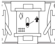
Bei Oberleitungsbetrieb beachten: Lok in Fahrtrichtung 1 (Führerstand 1) mit den linken Rädern auf die mit dem blauen Kabel verbundene Schiene stellen.
