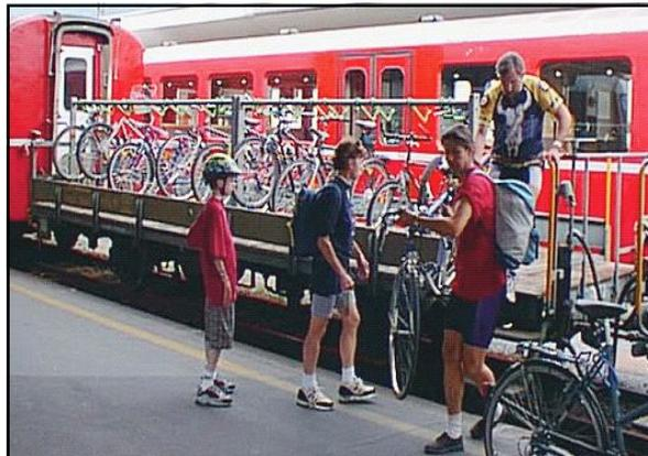
Als Sonderbauart entstanden bereits 1995 zwei **Velotransportwagen Lklp-v 7841/42**, auf Basis von vorhandenen gedeckten Güterwagen. Sie sollen die steigenden Nachfragen nach Fahrrad-Transportmöglichkeiten im Sommer befriedigen und verkehren vorwiegend in Reisezüge im Engadin.
