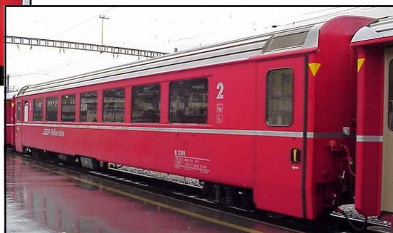
Die Einheitswagen IV wurden 1992/93 in zwei Varianten an die RhB geliefert: einmal normal lang für den Einsatz auf dem Stammnetz, sowie in verkürzter Bauart für den Übergang auf die Berninabahn. Von der normalen Ausführung wurden drei Erstklass- (A 1281-1283) und drei Zweitklasswagen (B 2391-93) gebaut. Die Stammnetz-Wagen sind rot lackiert.
