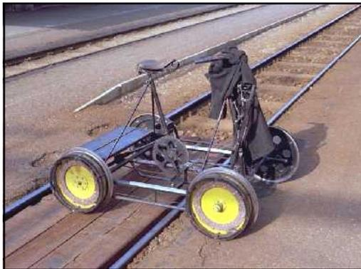
Die Rhätische Bahn unterhält für die Streckeninspektion **Schienen-Velos**, mit denen vor/bei Betriebsbeginn bestimmte z.B. durch herabfallende Felsbrocken oder umgestürzte Bäume gefährdete Streckenabschnitte überprüft werden. Das Velo wurde mit dem Zug bergwärts gebracht. Die Kontrollfahrt geht dann ins Tal hinab.
