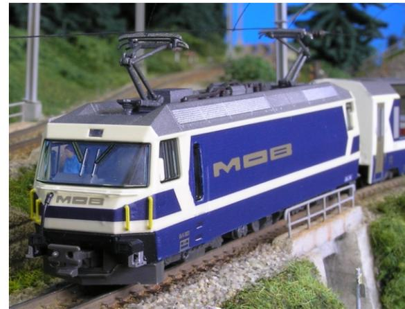
Die umgestaltete Front der Kato-Lokomotive wirkt mit den freistehenden Griffstangen noch vorbildlicher. Auch die Änderungen im Dachbereich lassen sich aus dieser Perspektive gut ausmachen. Bei entsprechender Nachfrage stellen wir alle vier Fahrzeugnummern auf die Gleise.
