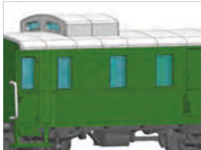
■ Dach mit Kanzel
