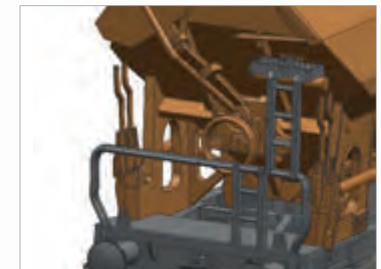
■ Aufwändige Nachbildung der Rangiererbühne und freistehende Hebel
