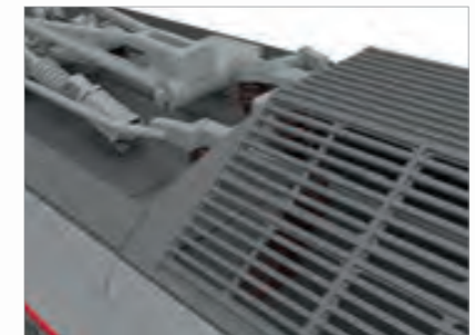
■ Durchbrochen dargestellter Dachaufbau aus Ätzblech
